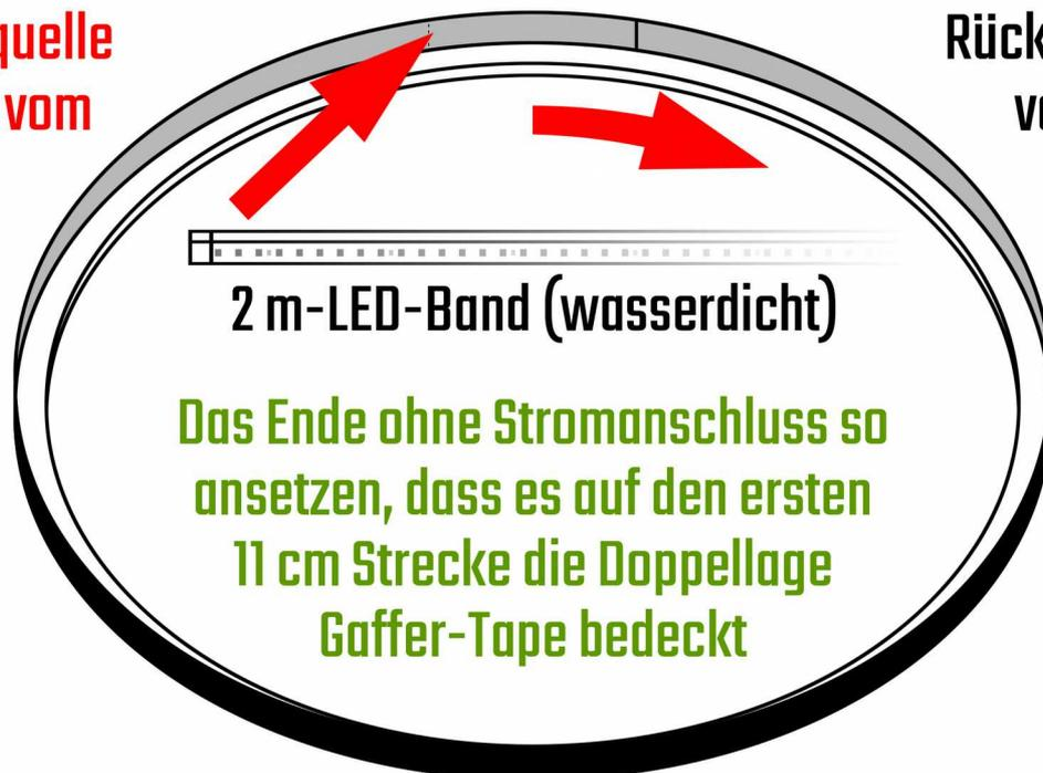
Um zu vermeiden, dass man beim Einkleben mit dem Licht-Band an unerwünschten Stellen gegen die offene Klebefläche kommt, kann man das LED-Band, beginnend mit dem Stromkabel so zu einer Schnecke eindrehen, dass die LEDs nach innen zeigen und das Ganze in der Mitte des liegenden Reifens in einem tiefen Teller platzieren. Dann zieht man sich automatisch beim Einkleben das Band nach und nach vom Teller.
