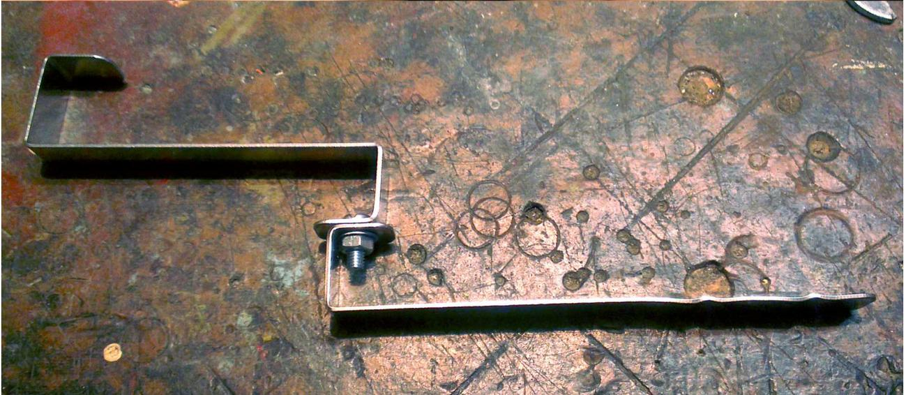
**Das in einer geraden Linie Verschrauben der beiden Tür-Kleiderhänger ist wohl mit die fummeligste Arbeit. Die Mutter wird so angezogen, dass die Schraube nicht mehr von Hand am Mitdrehen gehindert werden kann, ab dann muß die Schraube fixiert werden (Bild 2).**
